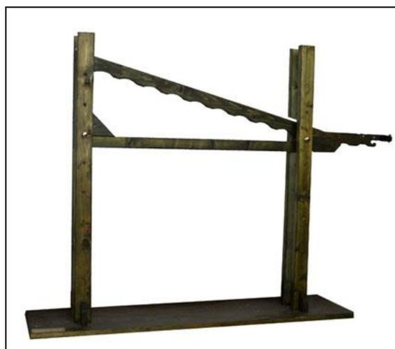
**Figura 7** ricostruzione trampolino Galileo per osservazione composizione moto
